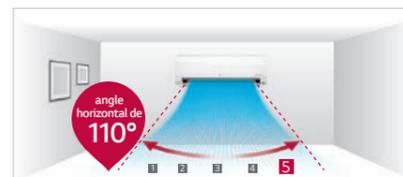
La direction du déflecteur air sur l'axe horizontal peut être réglée dans 5 positions différentes pour rafraîchir plus vite des zones spécifiques.
