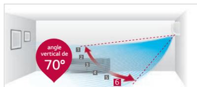
La direction verticale des déflecteurs air peut être réglée dans 6 positions différentes, de gauche à droite, pour pouvoir adapter le flux de l'air à la géométrie des locaux.
